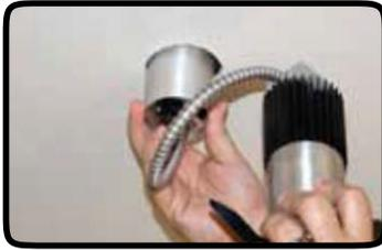
Insérez le tube de raccordement dans l'ouverture du plafond. Le tube de raccordement est conçu pour reposer simplement sur le matériau du plafond. (remarque : ce luminaire est conçu pour être installé dans un plafond non isolé. Voir l'illustration de l'installation ci-dessus.)
