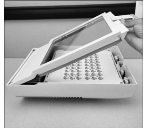
15. Re-hang door frame.
