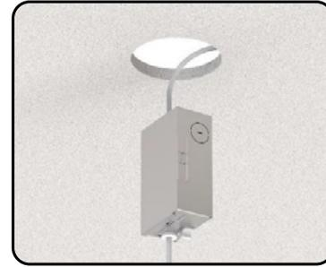
② Connectez le conduit de fil d'alimentation à la boîte de jonction du pilote distant, effectuez les connexions de fil et fermez correctement le couvercle de la boîte de jonction.
