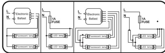
3) Si deux fils proviennent d'une douille existante (type allumage rapide), ces deux fils doivent être connectés ou shuntés ensemble.
