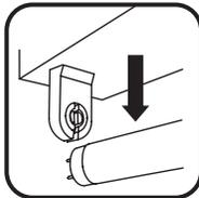
2) Retirez toutes les lampes fluorescentes et le ballast. Coupez les fils du ballast à environ 15 cm (6 po) de chaque douille.
