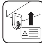
8) Installez l'étiquette d'avertissement à un endroit visible afin de s'assurer que l'utilisateur comprend que le système utilise désormais des tubes à double extrémité à DEL de type B et que l'utilisation des lampes fluorescentes peut entraîner des dommages matériels et des blessures.
