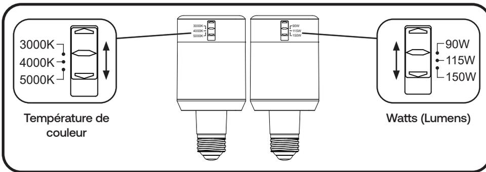
5. Réglez les commutateurs sur la lampe pour réaliser la performance souhaitée.
