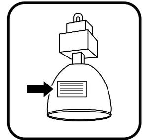
2. Ouvrez la boîte de jonction de l'appareil et contournez le ballast DHI, l'igniteur (le cas échéant) et le condensateur (le cas échéant) en débranchant les fils de ligne et de neutre et les fils noir et blanc des douilles aux endroits marqués « CROSS » sur le schéma.
