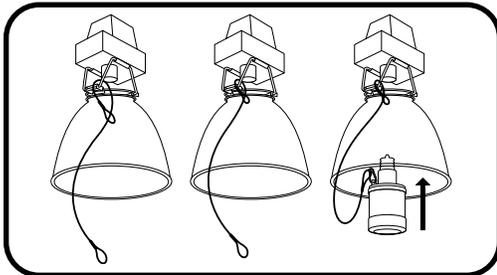
5A. Installez la lampe de conversion à DEL Current DHI dans la douille. Enroulez le fil de l'attache autour d'une structure de bâtiment porteuse, puis faites passer le fil dans la boucle à l'extrémité de l'attache avant d'utiliser le clip pour l'attacher à la lampe. Minimisez la longueur du fil attaché à la lampe. Attachez tout fil de surplus au besoin.
