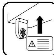
8) Installez l'étiquette d'avertissement à un endroit visible afin de s'assurer que l'utilisateur comprend que le système utilise désormais des tubes à double extrémité de DEL de type B et que l'utilisation des lampes fluorescentes peut entraîner des dommages matériels et des blessures.
