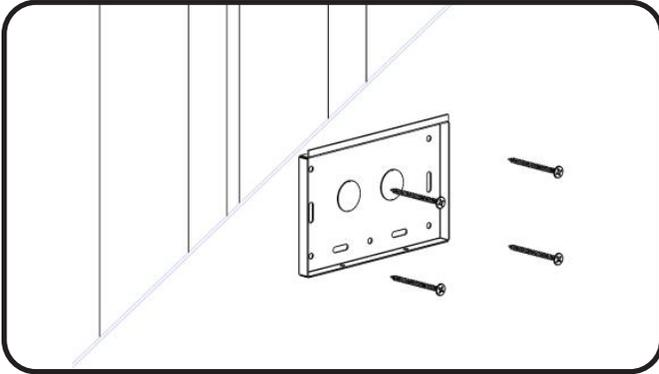
2 Cuando no se necesite conexión eléctrica, asegure el soporte de muro con la parte abatible hacia la pared. No retire los abatibles. Asegúrese de que todos los soportes estén nivelados antes de proceder.
