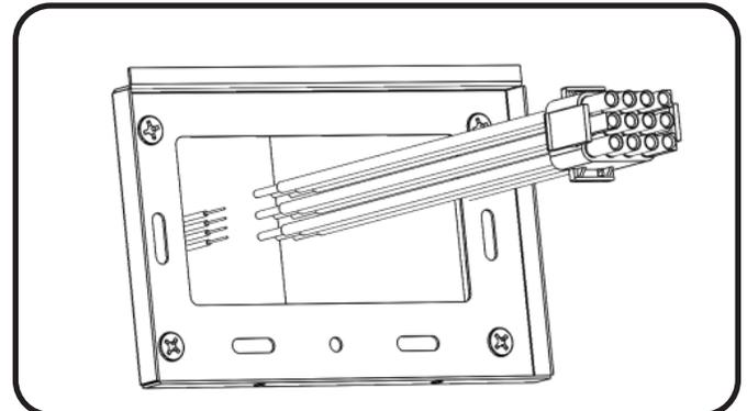
3 Conecte la línea del conducto al cable principal con los conectores de cable de torsión. Repita para la línea de atenuación. Tape los cables no utilizados.
