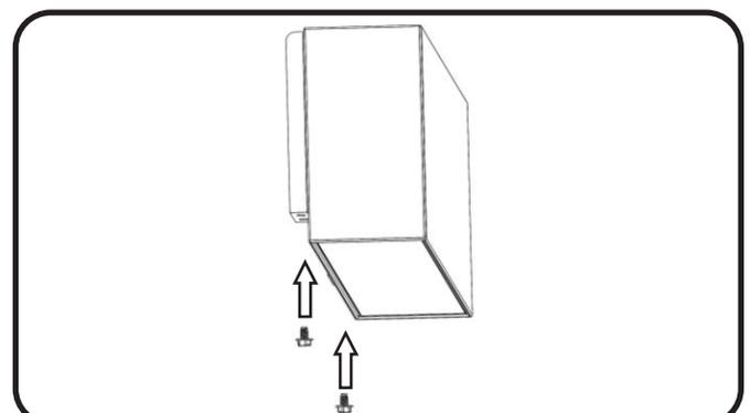
7 Gire el luminario hacia abajo, hasta que quede en su posición y asegúrelo con los ajustadores proporcionados.
