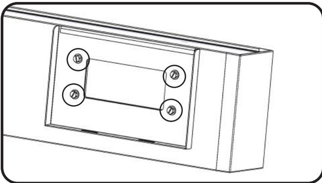
4 Asegure los soportes del luminario con los tornillos proporcionados, como se muestra. Los soportes no deben extenderse más allá de la carcasa, si se les instala correctamente.
