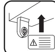
**8** Installez l'étiquette d'avertissement à un endroit visible afin de s'assurer que l'utilisateur comprend que le système utilise désormais des tubes à double extrémité à DEL de type B et que l'utilisation des lampes fluorescentes peut entraîner des dommages matériels et des blessures.
