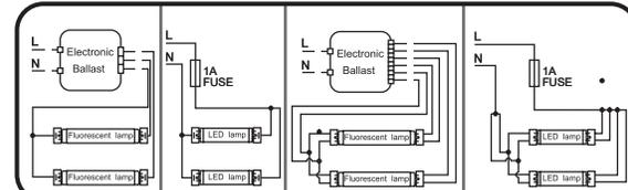
**3 - 7** 3) Si deux fils proviennent d'une douille existante (type allumage rapide), ces deux fils doivent être connectés ou shuntés ensemble.
