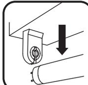
**2** Retirez toutes les lampes fluorescentes et le ballast. Coupez les fils du ballast à environ 15 cm (6 po) de chaque douille.
