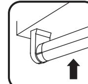
**9** Installez les tubes à double extrémité de type B.
