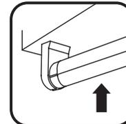
9) Installez les tubes à double extrémité de type B.
