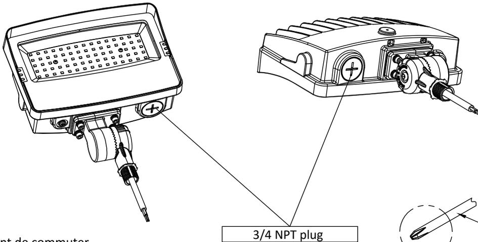
2. Retirez la prise avec un tournevis cruciforme de 6 mm. Mettez l'alimentation et le CCT comme illustré à gauche.
