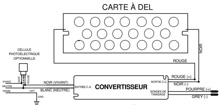
Fig 5B: DIAGRAMME DE CÂBLAGE POUR PROJECTEUR FML
